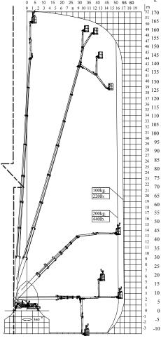
Arbeitshöhe und Reichweite. Maximal Ausladung.
